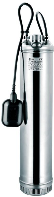
Pompe sommerse centrifughe multistadio da 5". Tutti i componenti a contatto con il fluido sono in acciaio AISI 304. Particolamente adatte per la distribuzione di acqua piovana, irrigazione, svuotamento fontane, impianti di lavaggio. La versione monofase è provvista di condensatore e protezione termica.
