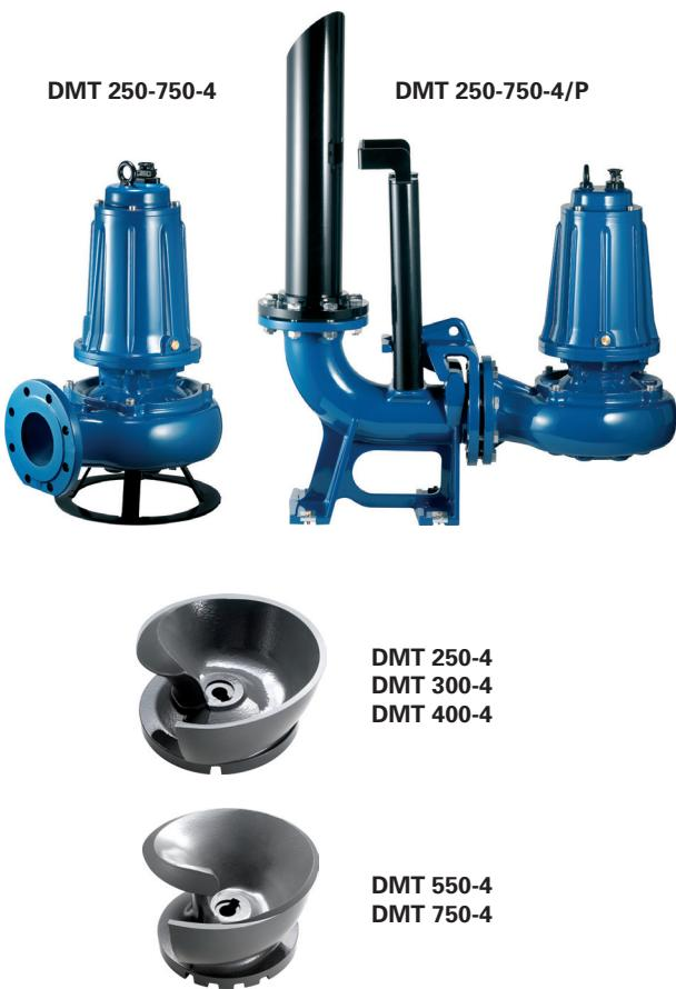
Pompe da drenaggio con girante centrifuga di tipo monocanale; garantisce, oltre ad una elevata portata un'ottima prevalenza; adatte ad applicazioni civili e industriali; sono state particolarmente progettate per uso estremamente gravoso; disponibili sia per applicazioni mobili e fissa con piede di accoppiamento.
