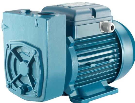
Pompa volumetrica ad anello liquido con girante stellare che conferisce alla pompa una notevole capacità aspirante. Particolarmente adatte nelle operazioni di travaso di liquidi (anche volatili). Corpo pompa con chiusura in ottone a riduzione del rischio di bloccaggio.
