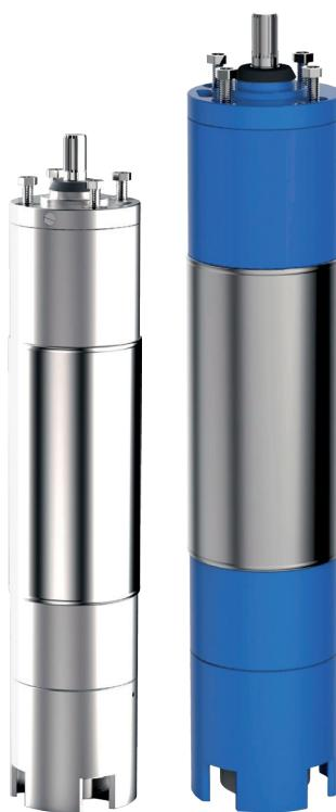
Motori sommersi riavvolgibili in bagno acqua 6", 8" e 10". Potenze da 4 kW fino a 150 kW. Disponibile con tenuta meccanica. Avvolgimento standard in PPC, disponibile versione in PE2+PA per temperature fino a 55°C. Versione in acciaio inossidabile AISI 304, AISI 316, DUPLEX disponibile.
