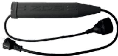
Naprava SLP je filter, ki je zasnovan tako, da preprečuje napetostne konice, ki jih povzročajo električne nepravilnosti ali motnje na omrežju. SLP v tem primeru prekine napajanje, saj lahko v nasprotnem primeru pride do poškodbe električne komponente vgrajene v ZDS črpalki. SLP se priporoča tudi v primeru, ko se uporablja generator z motorjem z notranjim izgorevanjem.
